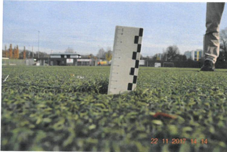
Foto Nr. 6: Beginnende Nahtöffnung mit deutlich erkennbarer Aufwölbung des Kunststoffrasens (Stoßkante)
