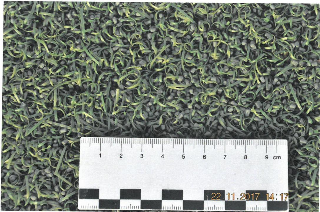
Foto Nr. 4: Das Einrollen der Bändchen ist deutlich geringer ausgeprägt als im östlichen Torraum. Ein Zeichen für eine unterschiedliche Nutzungsintensität im Trainingsbetrieb.
